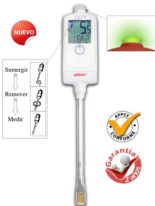
El Medidor de Compuestos Polares **CHM 330** permite determinar la calidad del aceite de fritura. La medición se efectúa directamente en el aceite caliente, introduciendo la sonda en la freidora.
